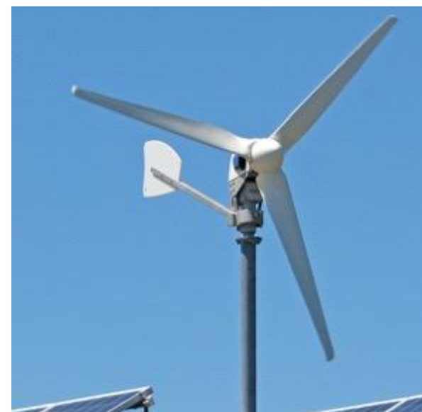
Slika: Primer vetrne elektrarne 3,5 kW za samooskrbo
