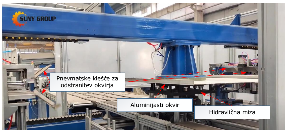
Slika 5.9: Naprava za odstranjevanje aluminijastega okvirja podjetja Suny Group [46]
